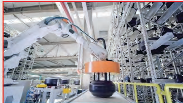
Automatisches Logistik- Transportsystem für grüne Reifen
